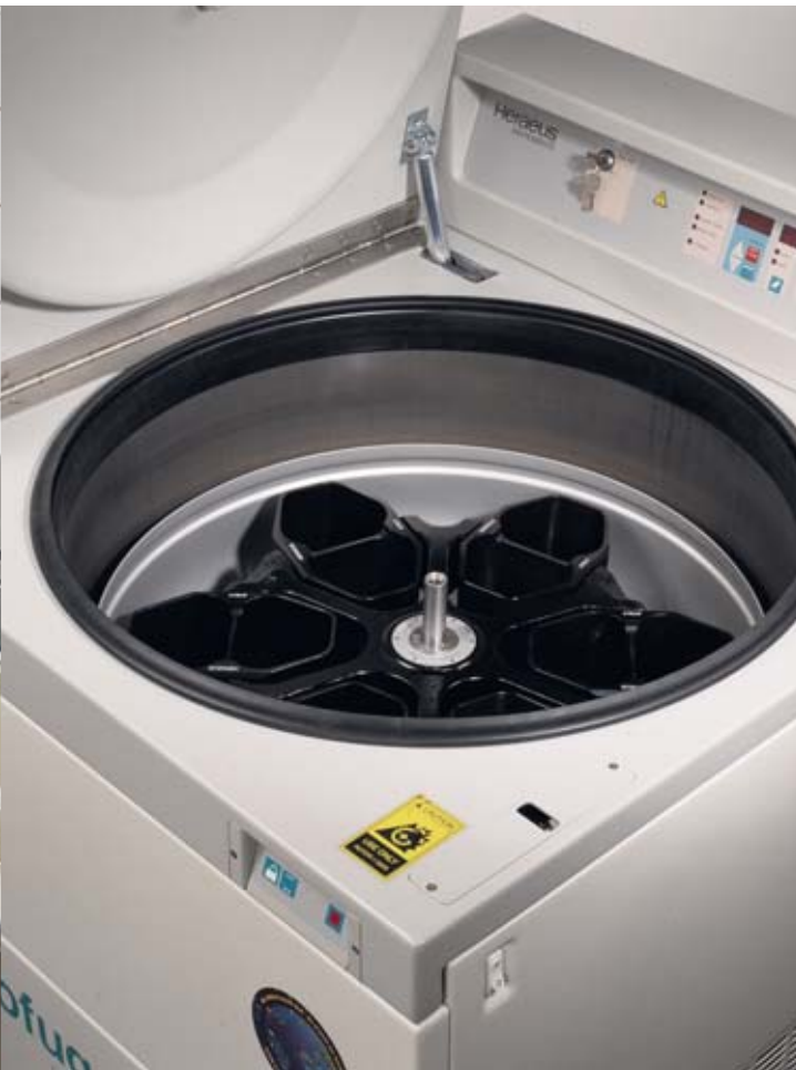
Blick in Hochleistungs-Kühlzentrifuge mit schwarz eloxierten Rotor und Bechern
