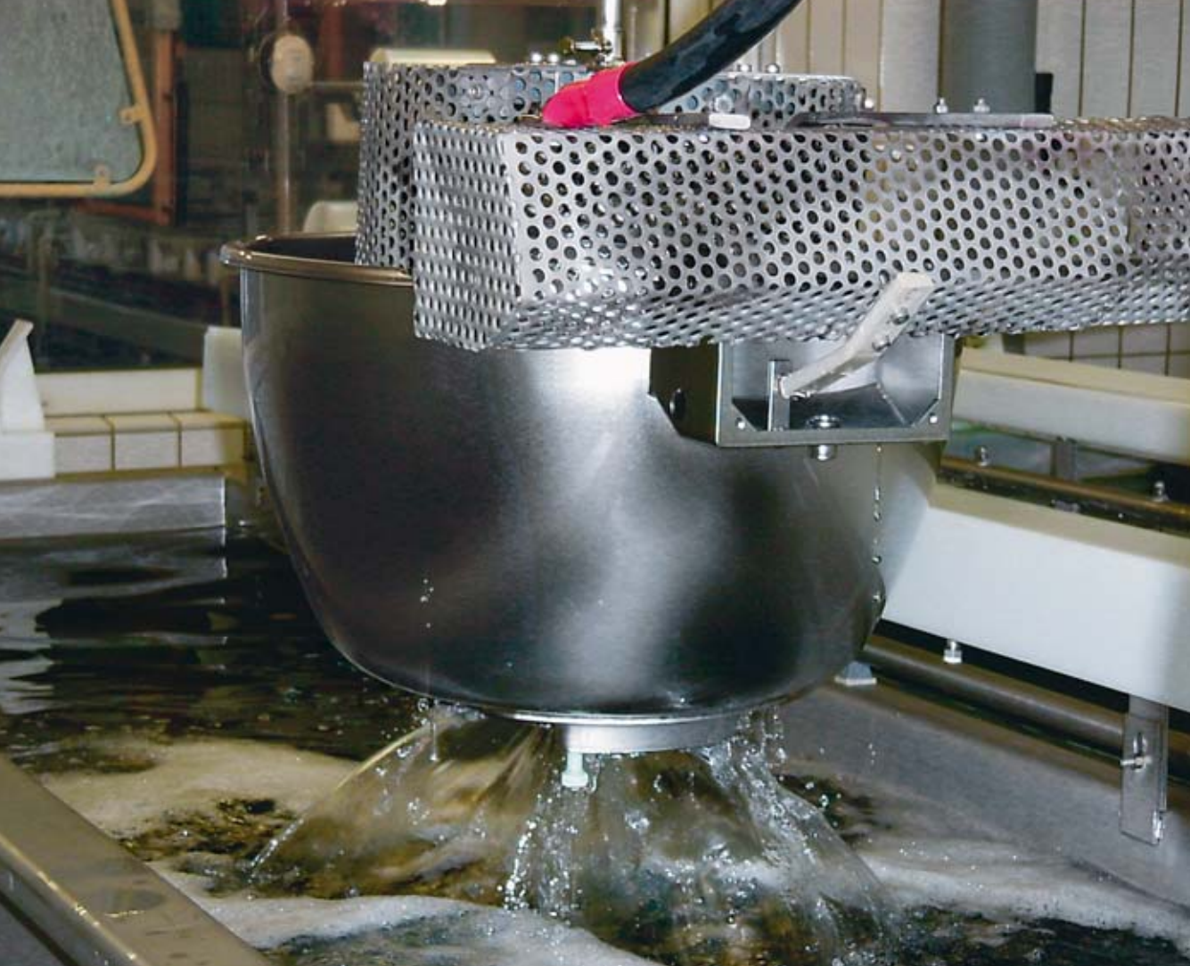
Backautomatkessel, mit Innenelektrode elektrolytisch poliert Baking-automat boiler, electrolytically polished with internal electrode
