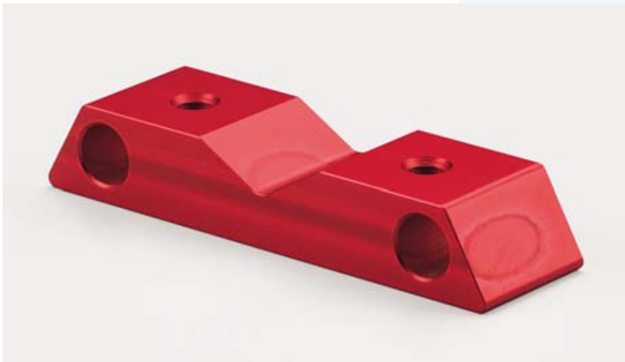
Abb. 3.1 Dasselbe Teil wie in Abb. 3.0; wieder enteloxiert, erneut eloxiert und rot gefärbt
