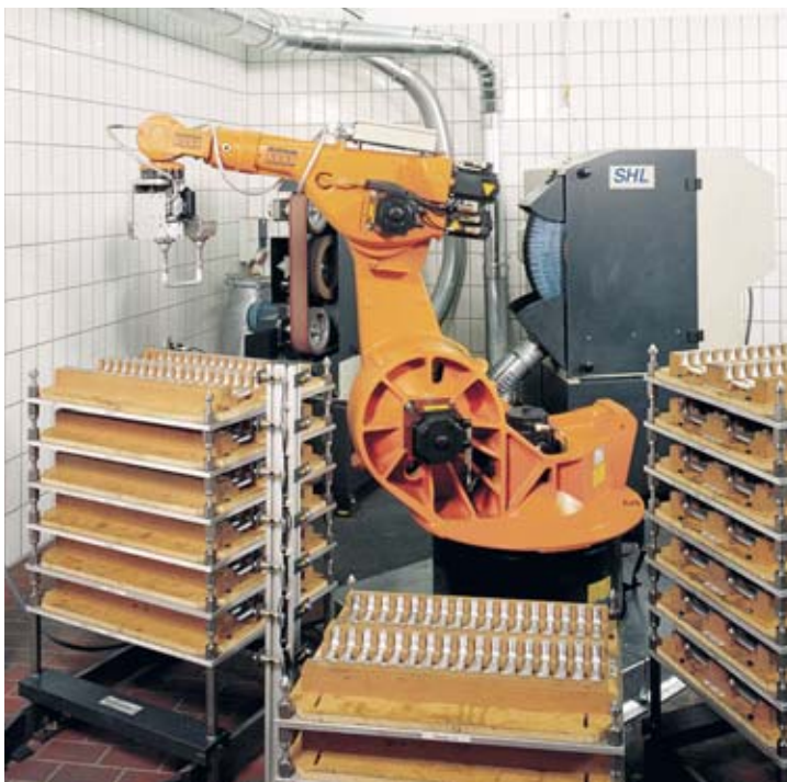
Roboter, Schleif- und Bürstanlage für Großserien von Aluminium-Artikeln Robot, grinding and brushing unit for large series of aluminium items
