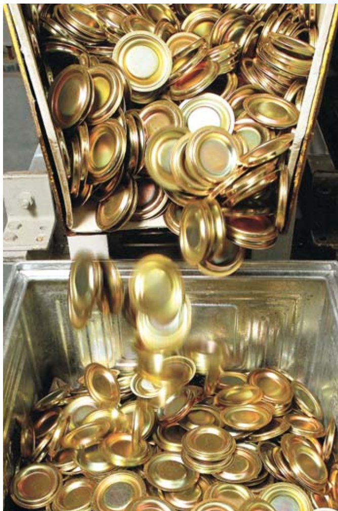
Stanzteile aus Stahlblech, trommelverzinkt und gelb chromatiert Punchings of sheet steel, barrel galvanized and yellow chromated
