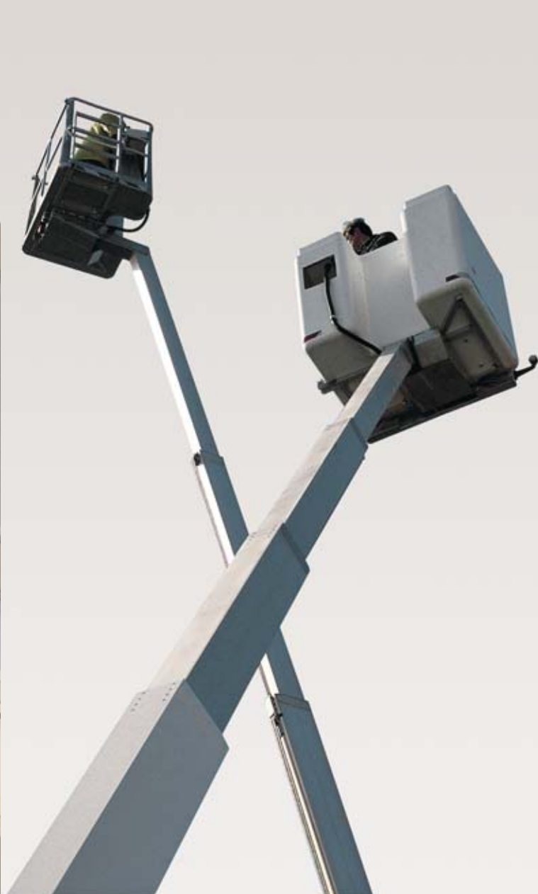
Hydraulische Hubarbeitsbühnen mit mattierten und eloxierten Aluminium-Teleskopmasten Hydraulic personnel platform lift with dull-finished and anodized aluminium free-lift masts
