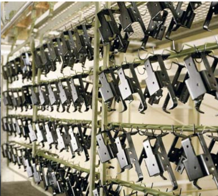
Warenträger mit verzinkt und schwarz chromatierten Bauteilen Racks with galvanized and black chromated components
