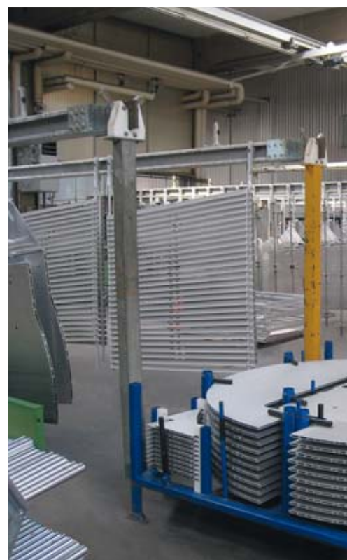
Unterschiedliche Aluminiumprofile geschliffen, gebürstet und eloxiert in den Farben Natur, Gold und Hellbronze Different aluminium profiles ground, brushed and anodized in the colours natural, gold and light bronze
