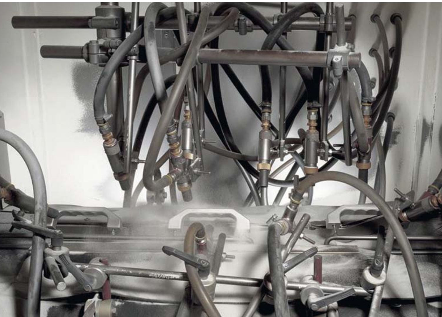
Blick in die Strahlkabine eines Glaskugel-Strahlautomaten; Aluminiumgriffe beim Durchlauf-Strahlen
