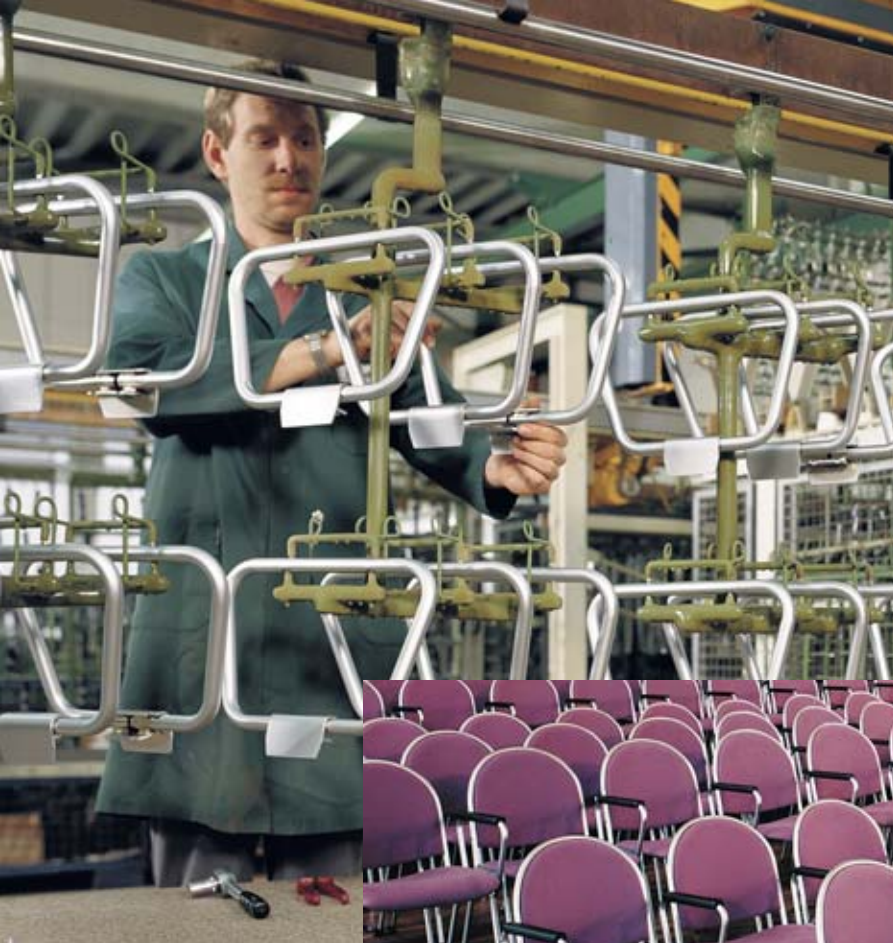
Warenträger mit Stuhlelementen nach dem Perlglanzverchromen Racks with chair arms after pearl-brightness chromium plating
