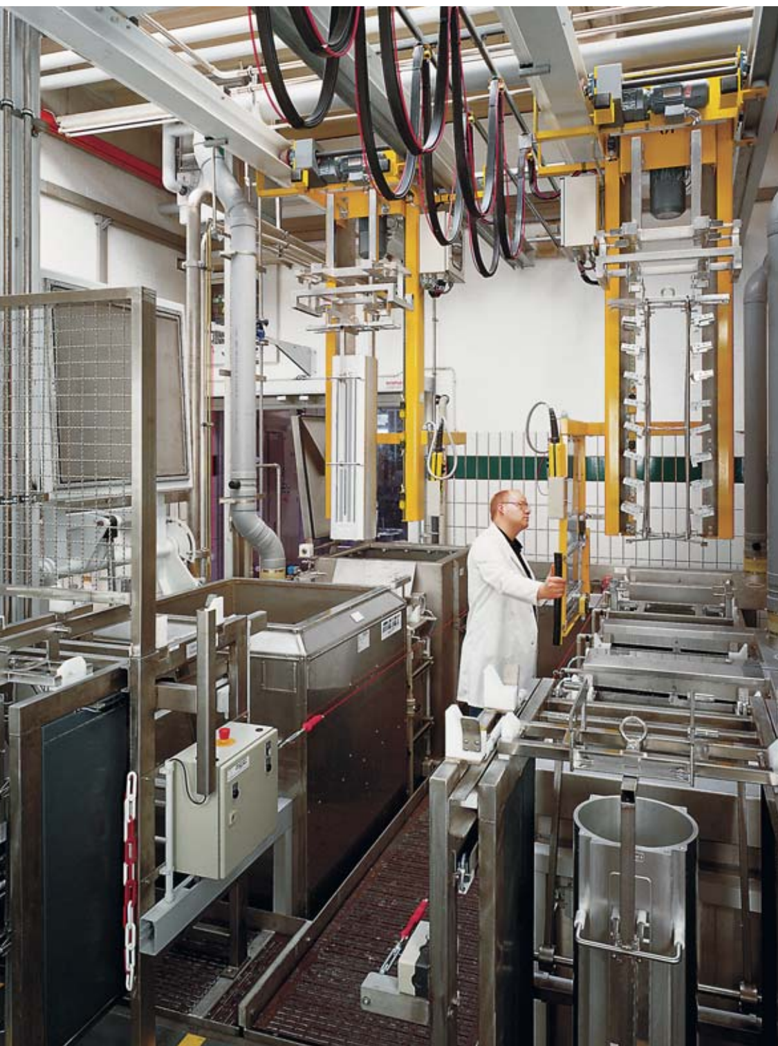
Teilansicht Reinbeizautomat für Aluminium-Bauteile; Laser-Reservoir beim Herausheben aus der Anlage
