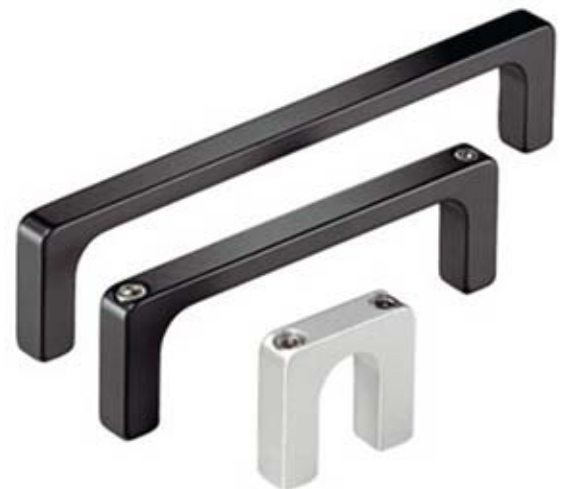
Aluminiumgriffe gleitgeschliffen, chemisch mattiert und naturfarben bzw. schwarz eloxiert Aluminium handles vibratory grinding, chemically dull- finished and anodized in natural colour or black
