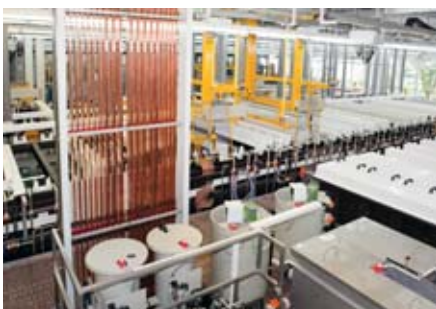
Galvanoautomat für „Gestellartikel“ Automatic electroplating plant for rack items
