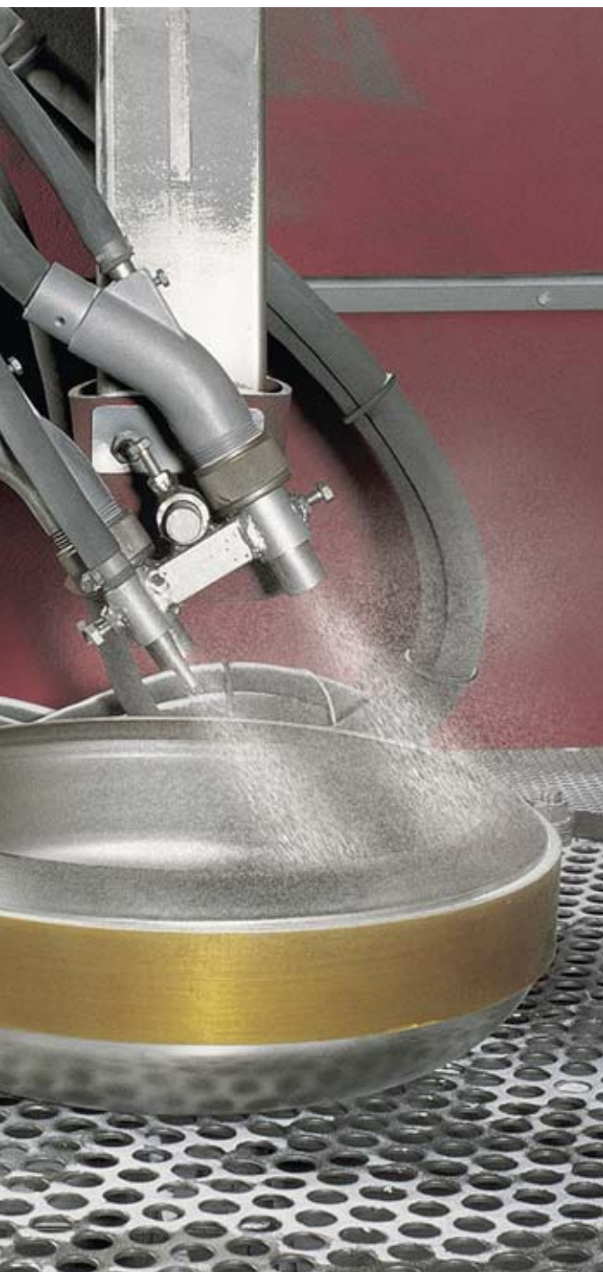
Blick in die Strahlkabine eines Glaskugel-Strahlautomaten; Edelstahlkessel auf Rotationstisch
