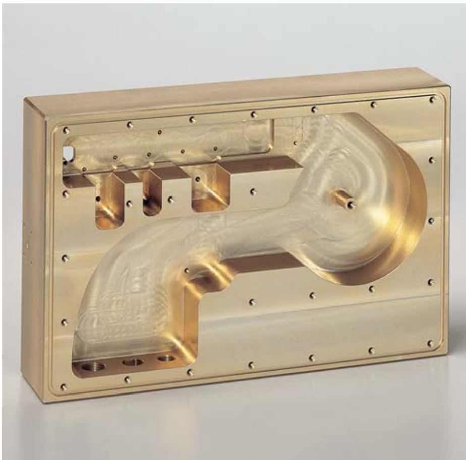
Gehäuse für die Kommunikationstechnik, gebeizt und gelb chromatiert Housing for the communication technology, pickled and yellow chromated
