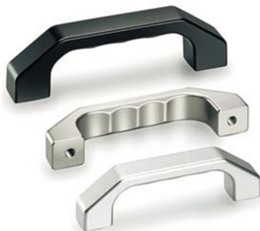
Aluminiumgriffe gleitgeschliffen, glaskugel-gestrahlt, satiniert und farblos bzw. schwarz eloxiert
