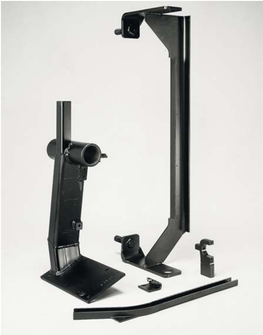
Bauteile aus Stahl und unterschiedlichem Gusseisen für ICE-Türen; Zink/Eisen legierungsbeschichtet Components made of steel and different kinds of cast iron for ICE doors; plated with a zinc/iron alloy
