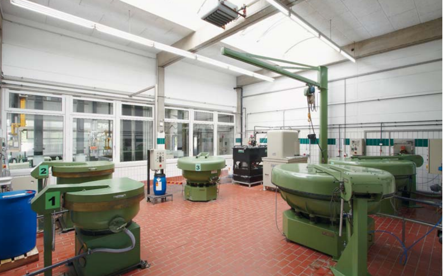
Gleitschleif-Rundanlagen für Artikel unterschiedlicher Abmessungen Circular machines for vibratory grinding of items with diverse dimensions
